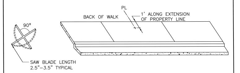
USE 3"-4" DIAMETER DIAMOND BLADE CIRCULAR SAW TO CUT CROSS AT PROPERTY LINE AS SHOWN
