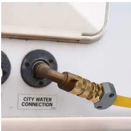
Línea de llenado del tanque no desmontables con un acoplador de desconectado rápido
